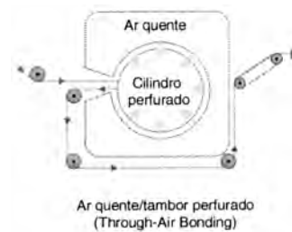
Fig. 15 – Processo de consolidação pela passagem de ar quente em Cilindro perfurado (Through-Air Bonding)
