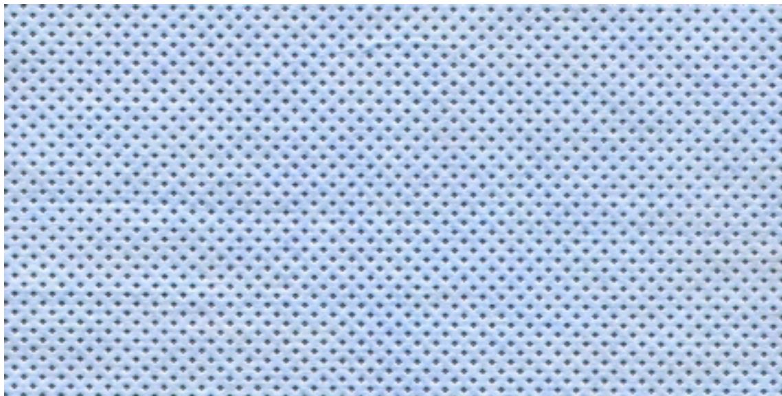
Nãotecido, 60 g/m 2 Spunbonded-Meltblown-Spunbonded (SMS), com filamentos 100% polipropileno, termoligado.
