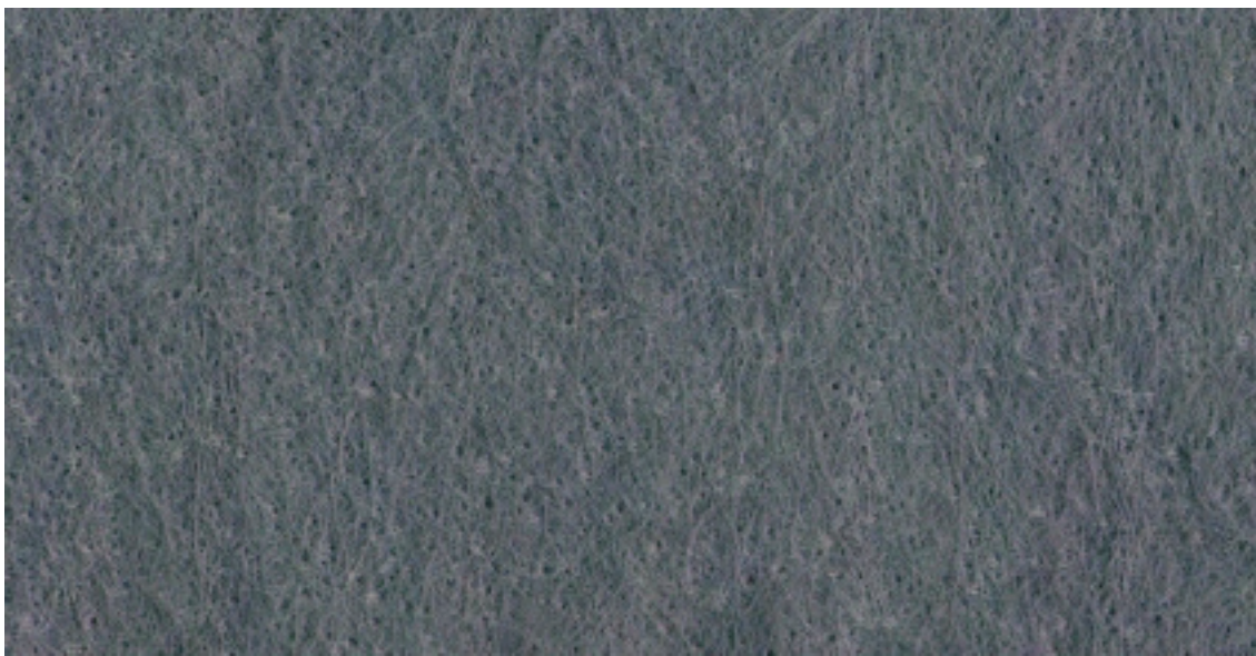
Nãotecido, 200 g/m 2 Cardado, com Fibras 100% polipropileno, agulhado.
