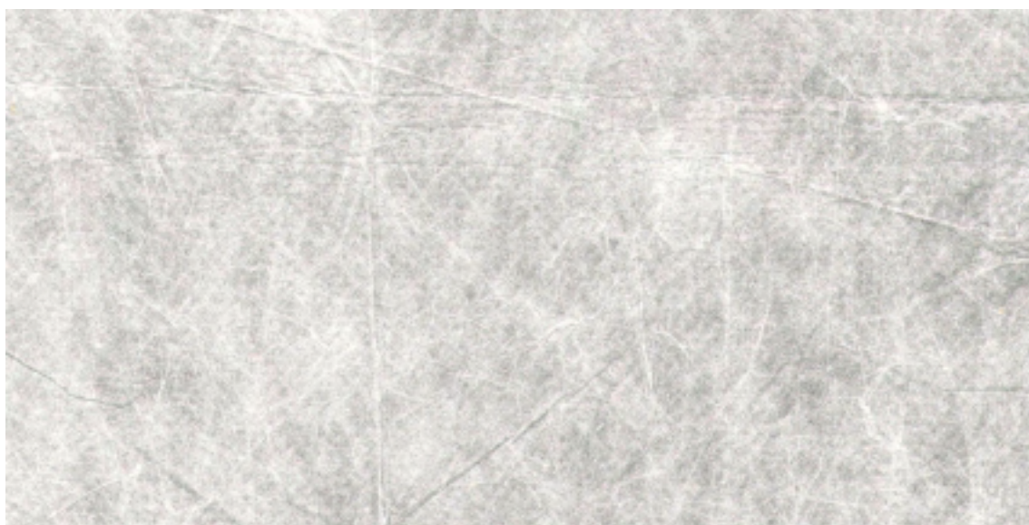
Nãotecido, 20 g/m 2 Meltblown, com 100% fibras de polipropileno, Termoligado.
