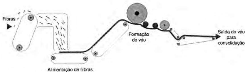
Fig. 4 – Processo de fabricação por Via Aérea/Fluxo de Ar (Air Laid).
