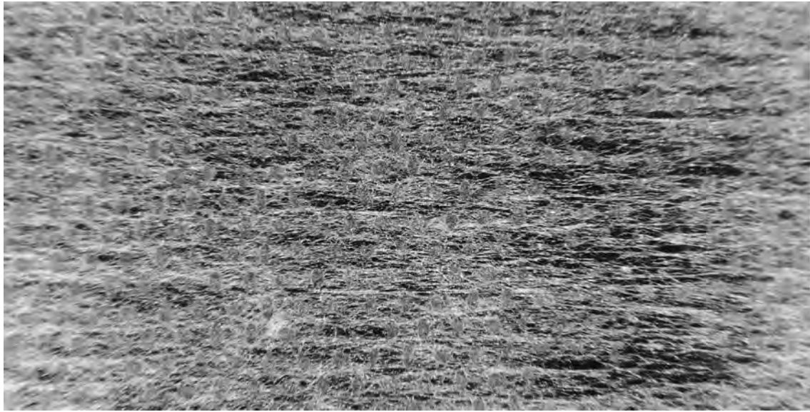
Nãotecido, 15 g/m 2 Spunbonded com Filamentos 100% polipropileno, Termoligado, com tratamento Hidrofílico
