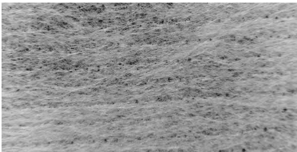
Nãotecido, 90 g/m 2 Cardado, com 100% fibras de poliéster, costurado (Stitchbonded) sem inserção de fios.
