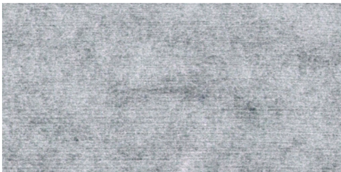
Nãotecido, 40 g/m 2 Cardado, com 100% de fibras poliéster, Spunlaced, Liso.
