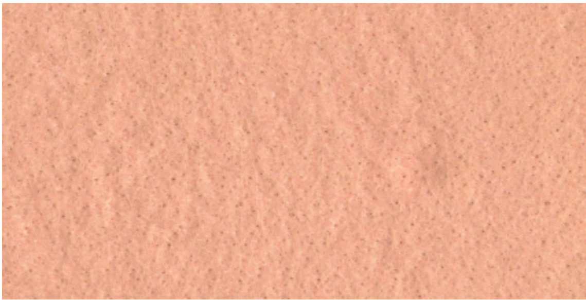
Nãotecido, 200 g/m 2 Spunweb com Filamentos contínuos 100% poliéster, agulhado
