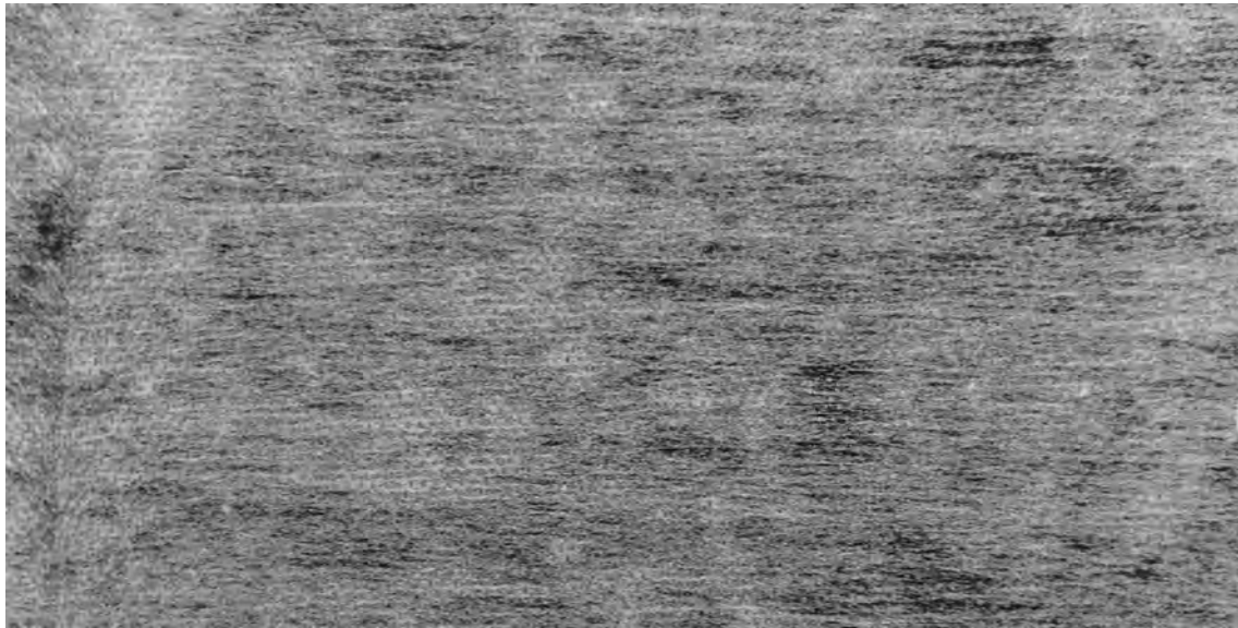
Nãotecido, 18 g/m 2 Cardado, com Fibras 100% polipropileno, Termoligado (Thermobonded).
